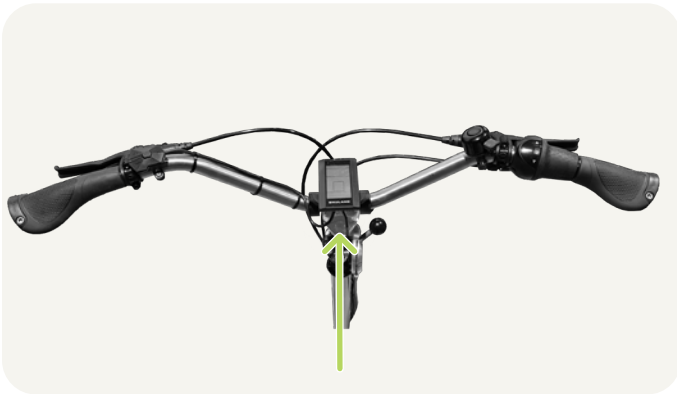
3 Draai de bout los met een steeksleutel
