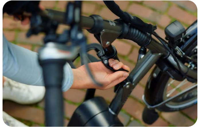
4 Met deze hendel kunt u het stuur verstellen
