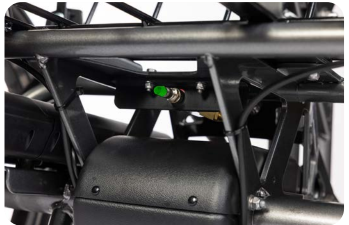
7 Het aanpassen van de luchtdruk kan onder de bagagemand.
