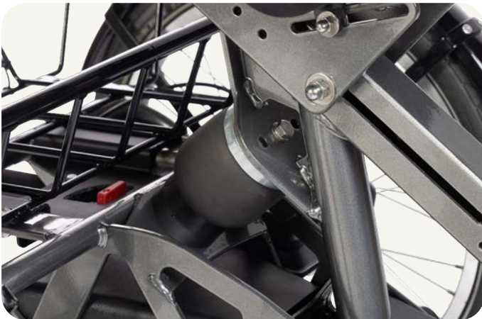
6 De luchtvering bevindt zich tussen de bagagemand en de stoel.
