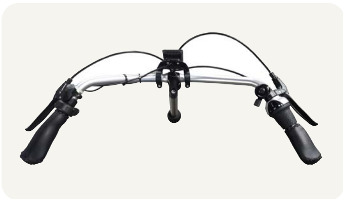
3 Draai de bout los met een inbussleutel
